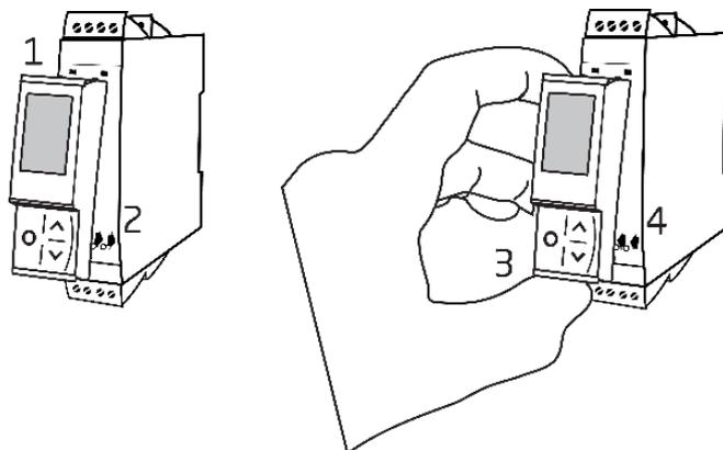
Montering af PR 4500-kommunikationsinterface:
